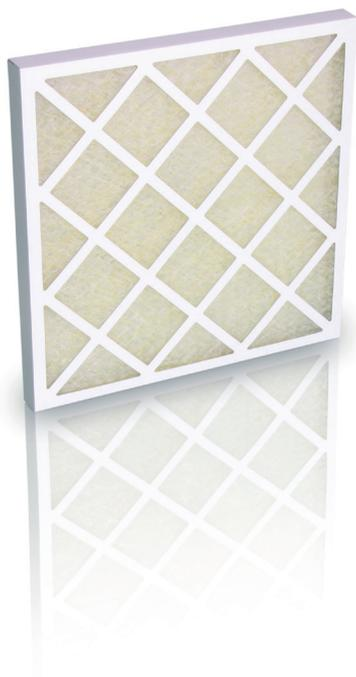
Typ HS-Glas Z 1" und HS-Glas Z 2" sind Filterzellen für Klima- und Lüftungsanlagen. Das Filtermaterial besteht aus elastischen Glasfasern, die zu einem flauschigen Glasfasergespinnst verarbeitet sind. Eingefaßt ist das Filtermedium mit einem stabilen Kartonrahmen.
